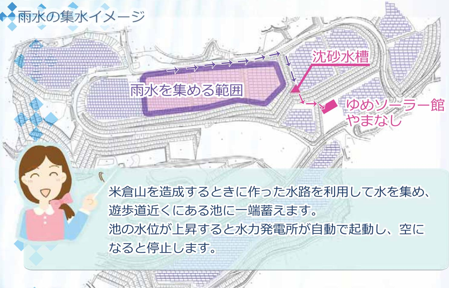
米倉山を造成するときについた水路を利用して水を集め、遊歩道近くにある池に一端蓄えます。池の水位が上昇すると水力発電所が自動で起動し、空になると停止します。
